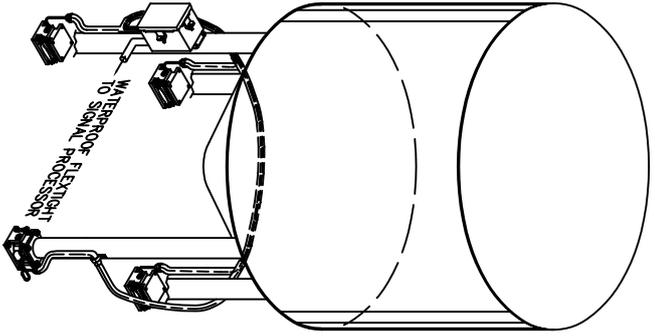
TYPICAL LOAD DISCS CABLE ROUTING ON VESSEL LEGS
